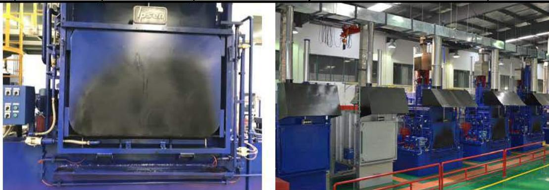
图 4.1-1 淬火炉自带开炉废气收集、燃烧装置
